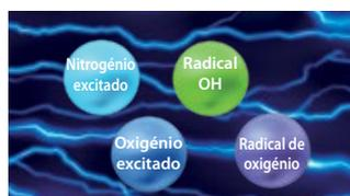
Os elétrons colidem e combinam com o nitrogênio e oxigênio no ar para formar quatro tipos de elementos.
