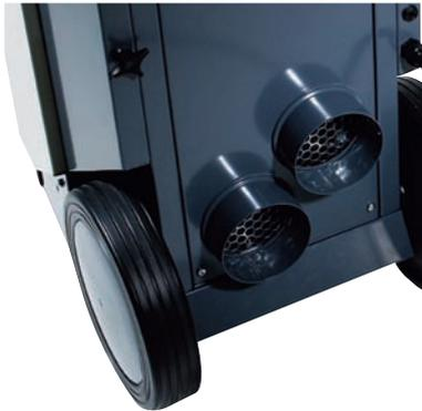
*Os modelos CDT 30S e CDT 40S são fornecidos com uma resistência eléctrica de 1kW e um ventilador de alta pressão que permite a ligação a duas condutas flexíveis circulares de  $\varnothing 100$ , cada uma com comprimento máximo de 5m.*
