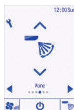
Controlo dos defletores
